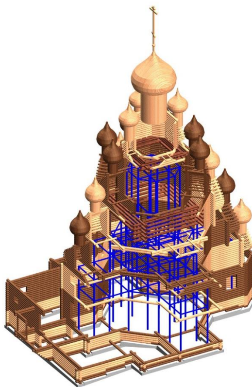
Рис. 2. Металлокаркас (синим цветом) внутри церкви Преображения Господня.
